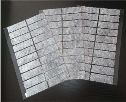
TASKMATEのドライ防錆テープは、多層構造になっており、表面は触ってもべたつかず、背面は付箋のような剥がれる粘着性を持ち、完全ドライ型の特殊防錆テープです。テープを貼り付け、密閉すればテープに含まれる無毒安全で空気より重い気化防錆剤が徐々に拡散され、強固なイオン膜で金属表面と空間を覆いテープ1枚で約0.3L~0.5Lを防錆します。
